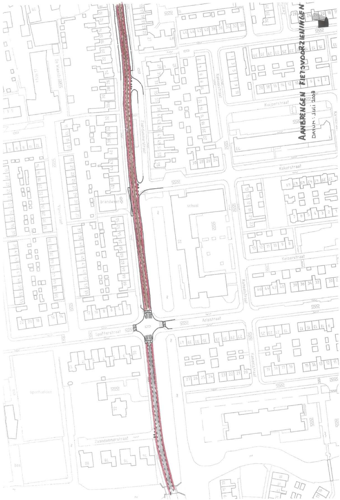
Figuur 7.7: Fietsvoorzieningen Zaandammerstraat met overgangskruipunt van eerste naar tweede deel
