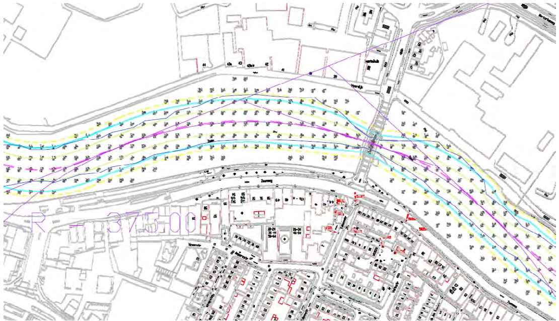
Figuur 4-3 Inpassing bochtstraal ( R = 375\text{ m} )
