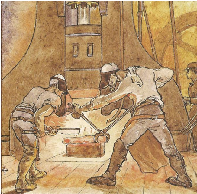
Een tekening uit 1872 van een stoom-smeedhamer. Een staaf ijzer wordt gehamerd tot een plaat smeedijzer. Het was zwaar handwerk.
