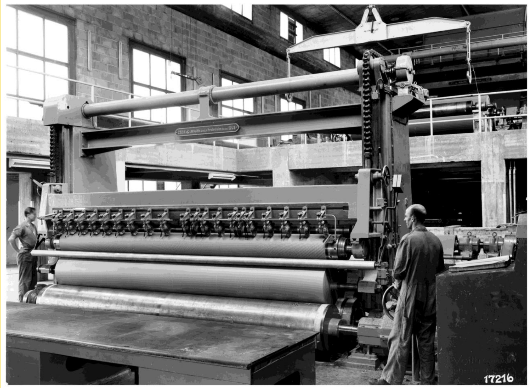
De bobineuse van PM 11, een snijmachine die een rol papier op breedte snijdt
